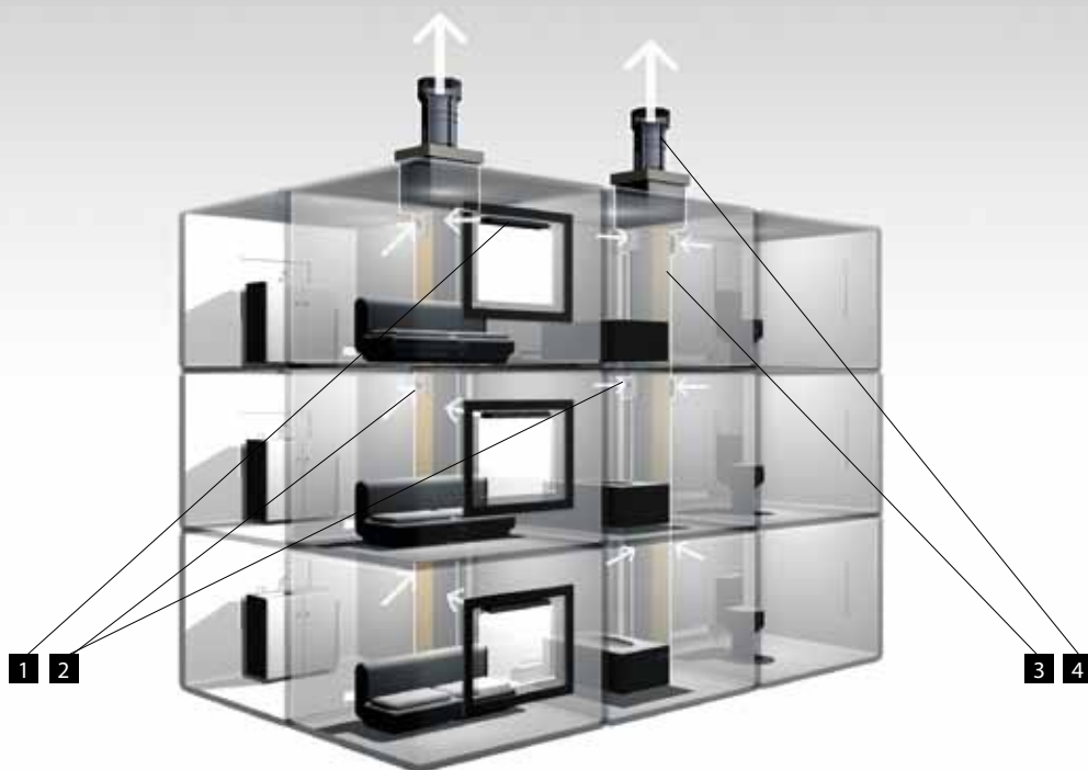
1.Приточные устройства. 2. Вытяжные устройства. 3.Вентиляционная труба. 4. Вентилятор для поддержания работы естественной вытяжки.
