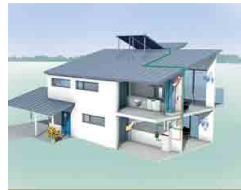
Гелиоколлекторы в сочетании с компактным устройством вентиляции жилых помещений LWP 300W с интегрированной системой ГВС
