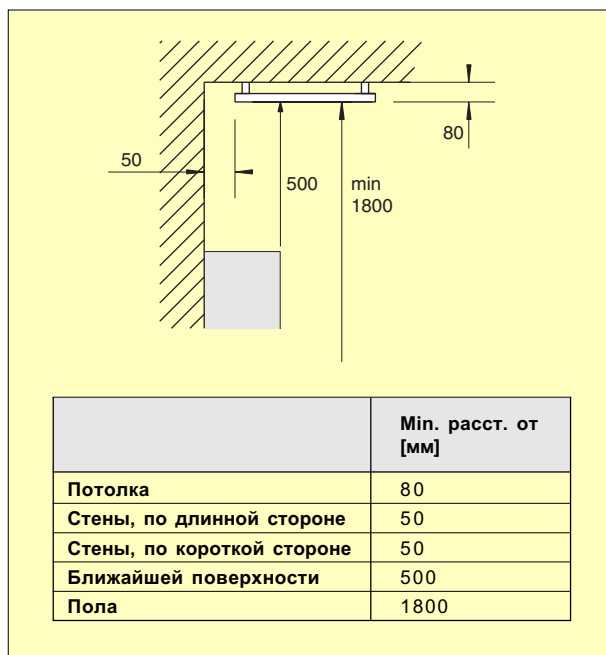
Рисунок. 2: Минимальные расстояния при установке.
