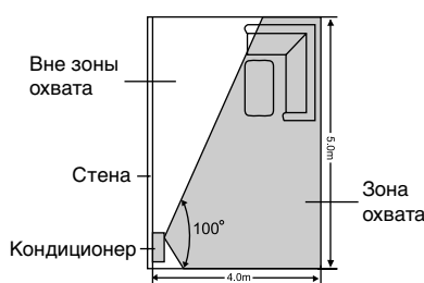
Кондиционер установлен в левой стороне комнаты
