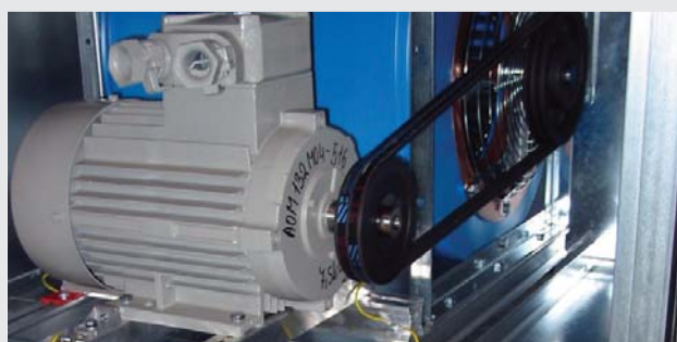
Искробезопасный вентилятор и двигатель во взрывозащищенном корпусе
