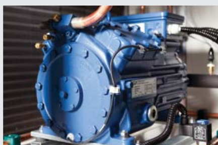
Поршневой компрессор с плавной регулировкой
