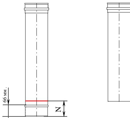
**П3.** Прикладываем укороченный участок внутренней трубы к наружной оболочке со стороны ее раструбного соединения. На наружной оболочке делается отметка места резки, при этом, укорачиваемый участок также должен равняться размеру **N**. При всем этом, аналогично требованиям и процессу, описанному выше, наружная труба-оболочка укорачивается вместе с находящейся в ней теплоизоляцией только со стороны гладкой вставки (см. рисунок).
