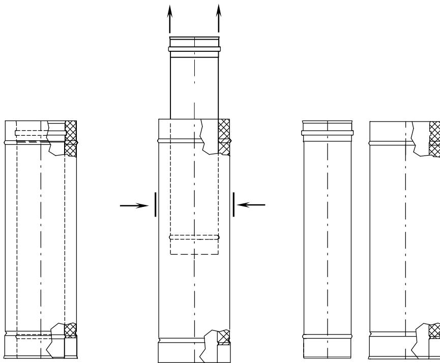
**П2.** Далее, с помощью ножовки или болгарки, укорачиваем на необходимое расстояние  $N$  внутреннюю трубу строго со стороны гладкой вставки, т. е. раструбное соединение должно осться не тронутым. При этом нужно всегда помнить о следующем:
