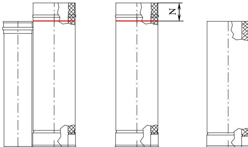
**4.** Придерживая укороченный участок наружной трубы-оболочки с теплоизоляцией, устанавливаем в нее гладкой стороной участок внутренней трубы до полной посадки заподлицо с кромками. После чего данный элемент можно устанавливать в соответствующий участок дымохода.
