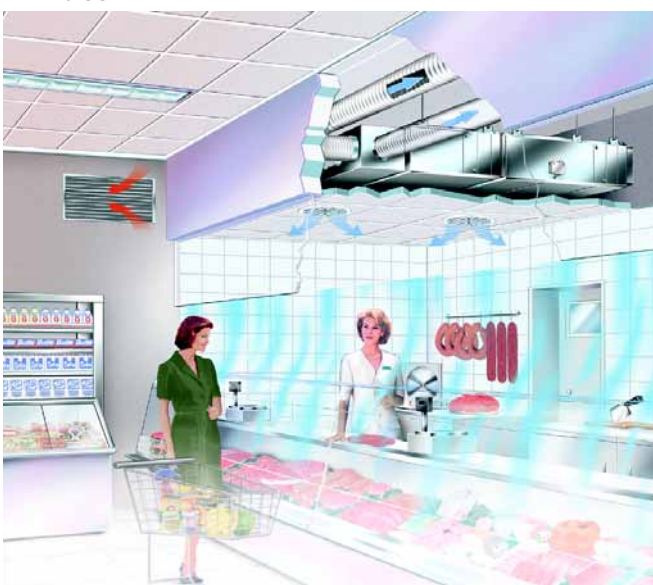
Рециркуляционные модули с фильтром класса S вентиляционной системы, обеспечивающей избыточное давление в помещении продажи сыра и мяса.
