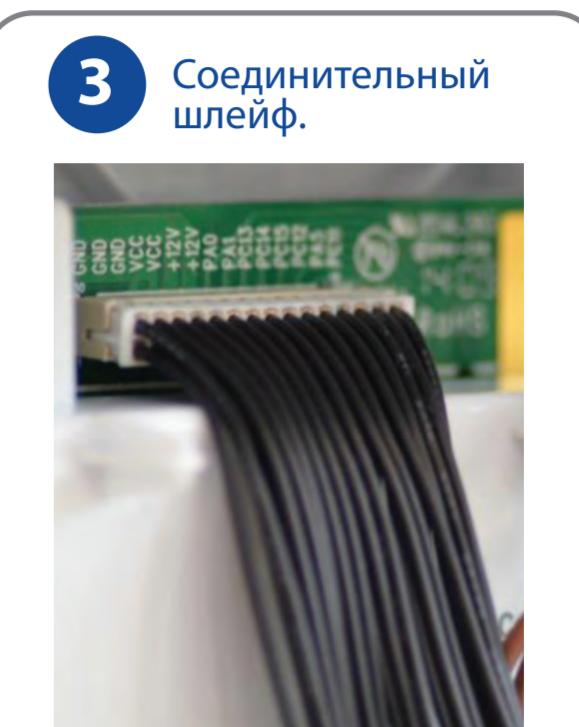
Будьте осторожны при снятии наружной крышки центра! Аккуратно отсоединяйте шлейф, при обратном подключении соблюдайте правильность расположения.
