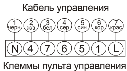
Рис.4. Схема подключения кабеля к пульту управления.
