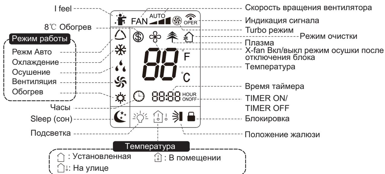
Данный пульт (YAA1FB) является универсальным и подходит для управления любым бытовым кондиционером марки TOSOT, поэтому некоторые кнопки и функции будут неактивными в зависимости от серии кондиционера. Уточнить какие функции доступны в той или иной модели можно в инструкции пользователя или каталоге TOSOT.
