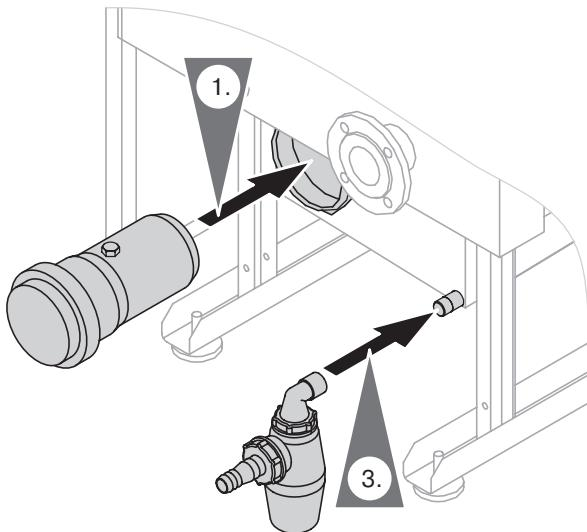
1. До отказа вставить патрубок подключения котла (принадлежность) в патрубок отходящих газов.
