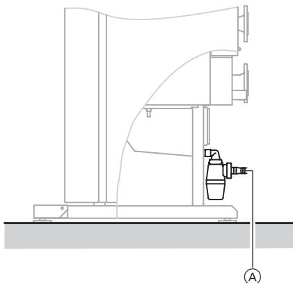
Проложить линию отвода конденсата под уклоном ниже уровня обратного подпора газовыпускного коллектора.
