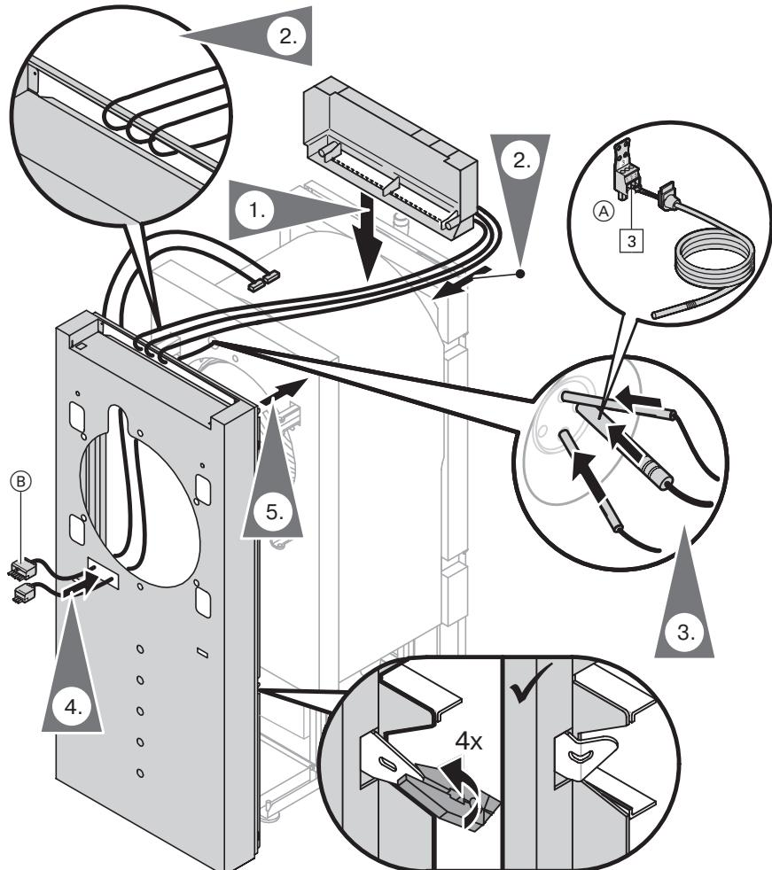
(A) Датчик температуры котловой воды [3] (B) Кабели горелки [41] и [90]
