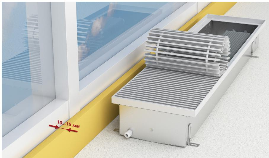
3. Размеры отопительного канала должны иметь припуск по высоте (H) +10...15 мм, по длине (L) +100...300 мм и ширине (B) +150 мм по отношению к габаритным размерам конвектора.
