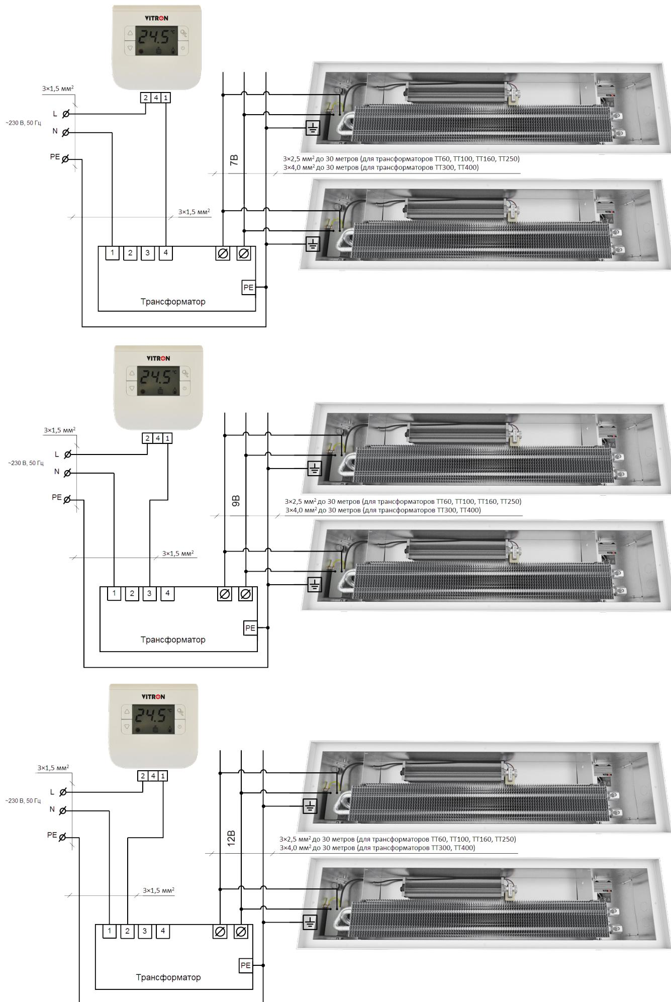
При подключении к трансформаторам ТТ60, ТТ100, ТТ160, ТТ250 использовать провод 3×2,5 мм<sup>2</sup> до 30 метров.
