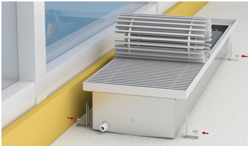
2. Установить конвектор в отопительный канал, после чего с помощью юстировочных винтов (поз. 6) выровнять корпус конвектора в горизонтальной плоскости с допуском  $\pm 1$  мм. При выравнивании конвектора необходимо учитывать, чтобы верхняя кромка декоративной рамки (или окантовки) (поз. 3), находилась заподлицо с напольным покрытием;
