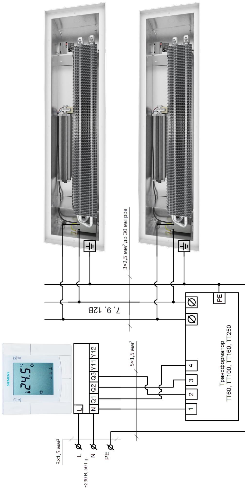
При подключении к трансформаторам ТТ60, ТТ100, ТТ160, ТТ250 использовать провод 3×2,5 мм<sup>2</sup> до 30 метров.
