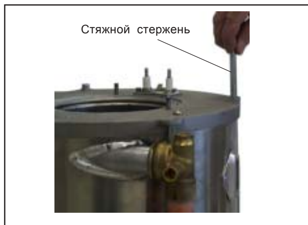
Рис.: Стяжной стержень большой крышки камеры сгорания
