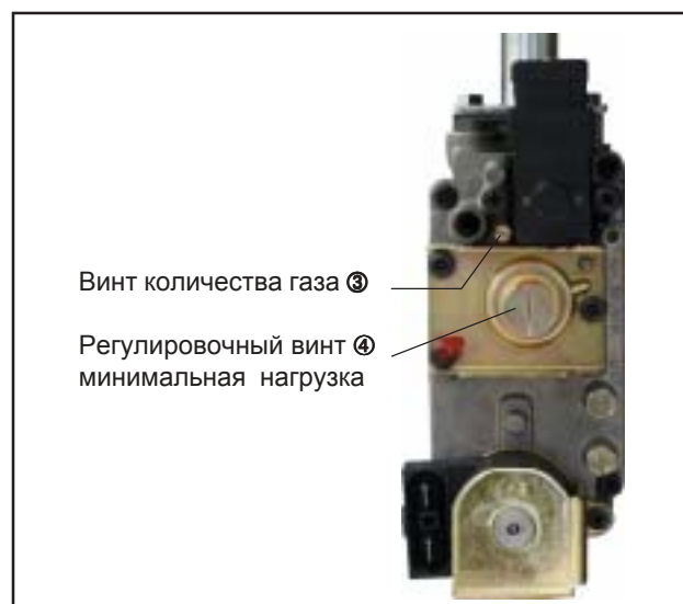
Рис.: Установка значений CO 2
