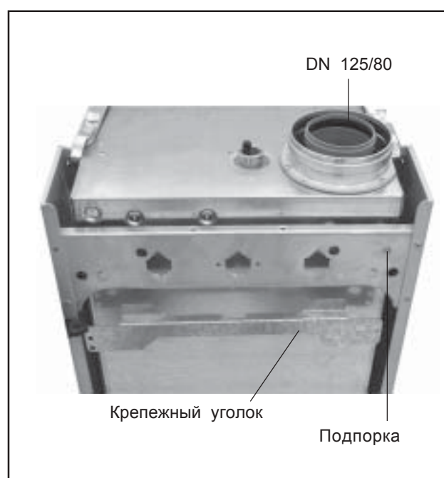
Рис.: Навесить газовый настенный конденсационный котел на крепежный уголок
