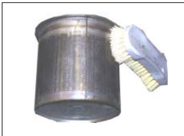
Рис.: Чистка горелки
