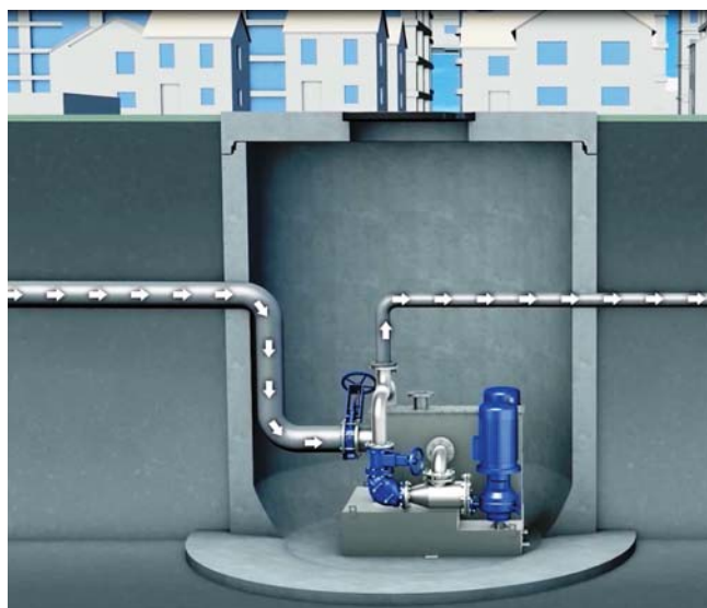
Отвод стоков с помощью установки AmaDS
