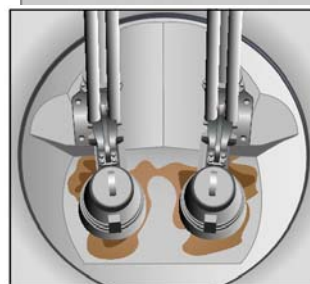
Рис. 2. Насосная станция Flygt TOP с конусным дном оптимальной конструкции
