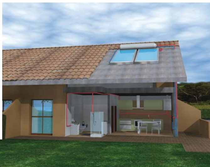
Рис. 3. Схема ГВС с плоским гелиоколлектором
