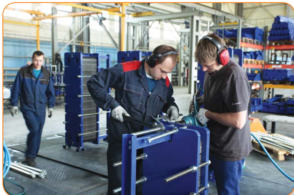
Рис. 3. Заводская сборка разборного пластинчатого теплообменного аппарата
