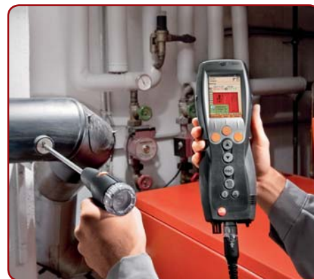
Анализ дымовых газов с помощью testo 330-2 LL
