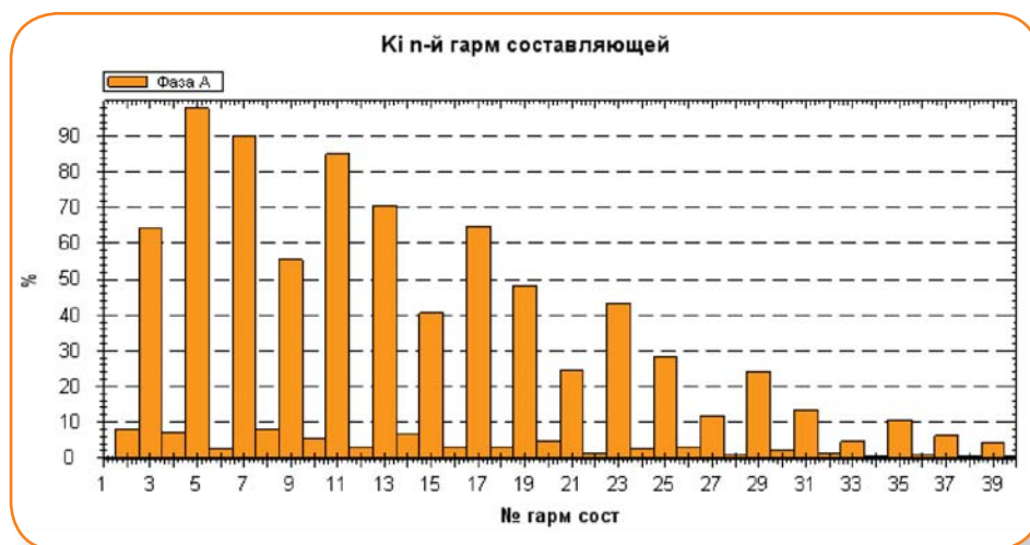
Рис. 4. Гармонический спектр токов на участке от источника питания до ЧРП
