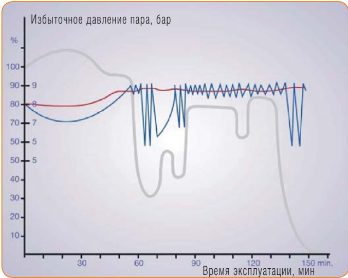
Рис. 4. Изменение давления пара жаротрубно-дымогарного и прямоточного паровых котлов: — Типичный график расхода пара. — Давление пара на выходе жаротрубно-дымогарного котла. — Давление пара на выходе прямоточного котла
