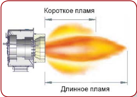
Рис. 2. Регулировка формы пламени горелочных устройств типа URB
