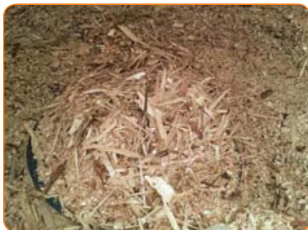
Скопление щепы большего, чем допустимо, размера в топливохранилище и рессорной мешалке
