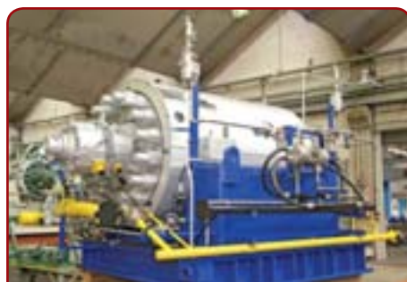
Питательные насосы типа CHTA/CHTC/CHTD: DN (мм) – 100–500, Q (м³/ч) – до 3700, H (м) – до 5300, p (бар) – до 560, T (°C) – до +210
