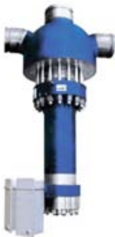
Рециркуляционный насос котла типа LUV/LUVA: DN (мм) – 100–550, Q (м³/ч) – до 7000, H (м) – до 300, p (бар) – до 350, T (°C) – до +380
