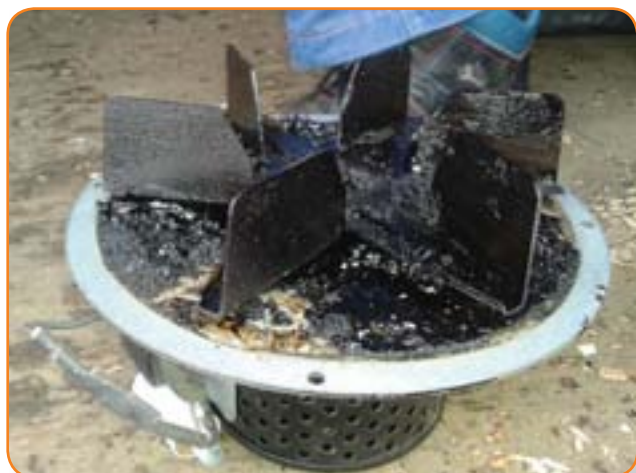
Внутренняя часть дымохода, покрытая отложениями дегтя
