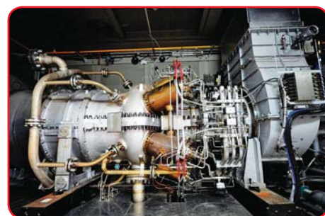
Сердце ГТУ – газовая турбина M7A (КНИ)
