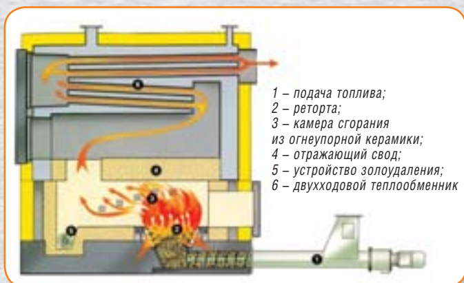
Пример котла со сжиганием древесины в реторте
