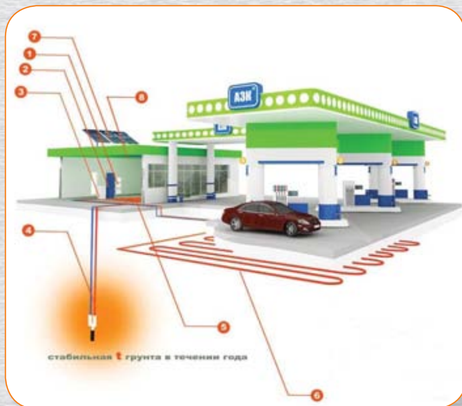
Рис. 3. Принципиальная схема теплоснабжения АЗС с помощью теплового насоса:
