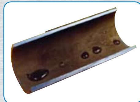
Рис. 3. Фрагмент трубы с защитным слоем на внутренней поверхности, сформировавшемся после применения препарата Odacon
