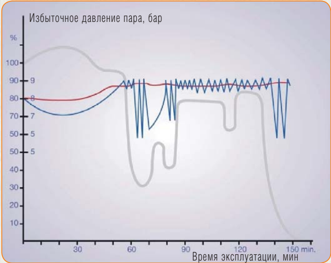
Рис. 4. Изменение давления пара жаротрубно-дымогарного и прямоточного паровых котлов — Типичный график расхода пара — Давление пара на выходе жаротрубно-дымогарного котла — Давление пара на выходе прямоточного котла
