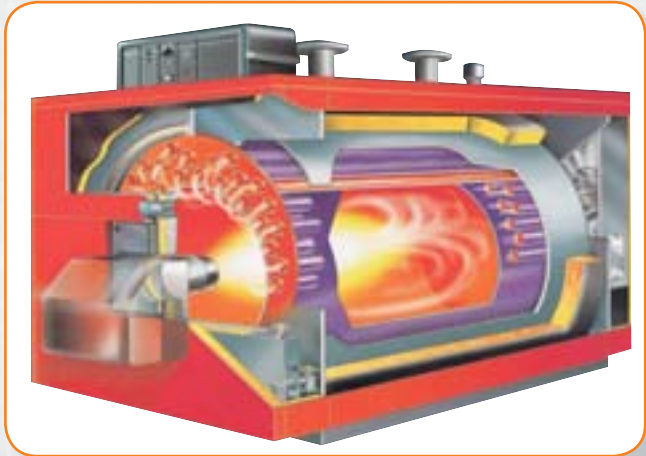
Рис. 1. Схема работы двухходового жаротрубного котла
