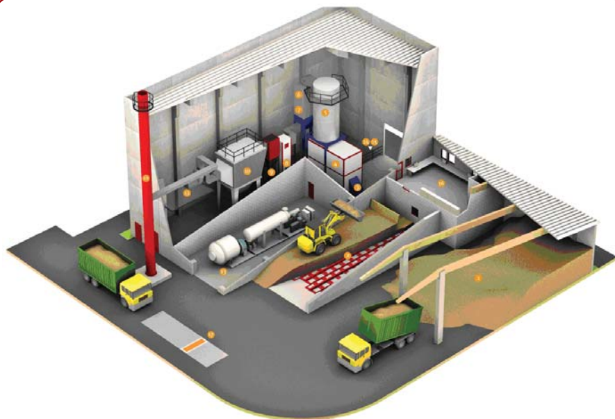
Рис. 4. Автономный энергоцентр Эрлингхаузен с когенерационной установкой ОЦР на базе термомасляного котла Kohlbach и турбогенератора Turboden:
