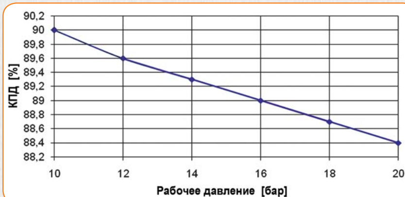
Рис. 4. Зависимость КПД трехходового парового котла от его рабочего давления
