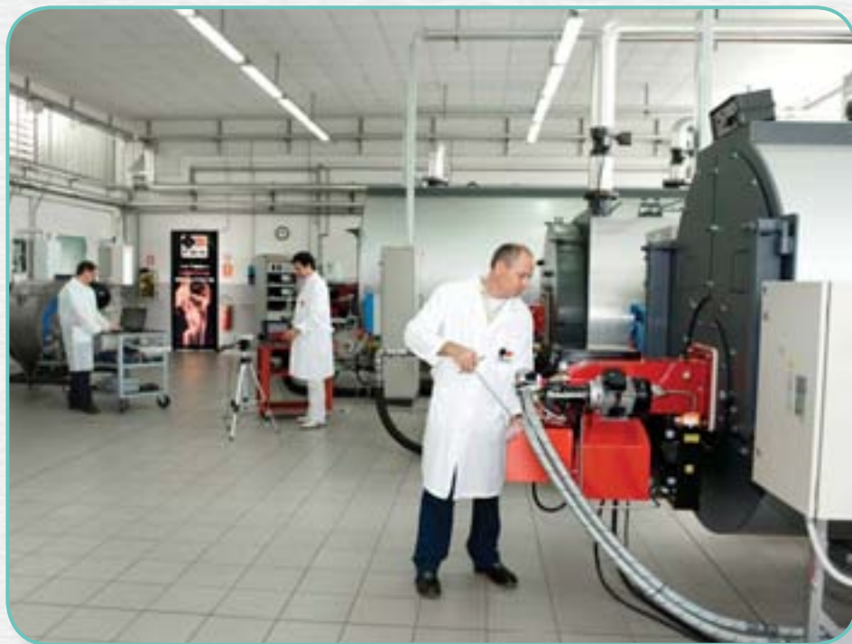
Рис. 4. Идет испытание работы горелочного устройства F.B.R. на жаротрубном паровом котле
