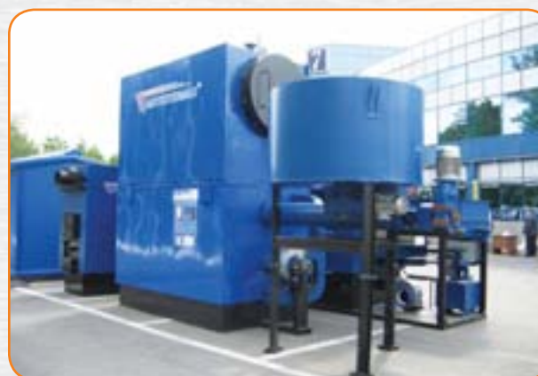
Рис. 3. Твердотопливный водогрейный котел «Балткотломаш» с механизированной подачей щепы
