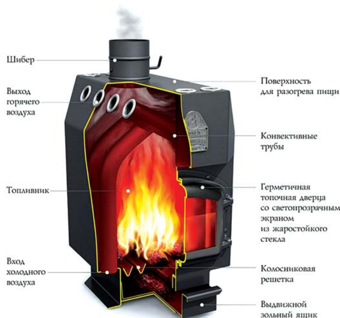
Рис. 3. Конструкция печи-камина
