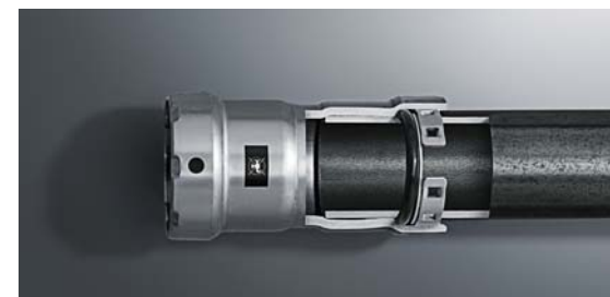
При опрессовке стопорное кольцо входит в трубу и обеспечивает соединению особую надежность
