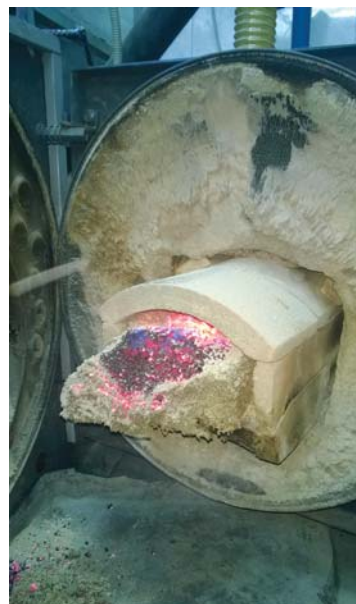
Работа горелки на некачественных пеллетах приводит к коксованию и спеканию в корж
