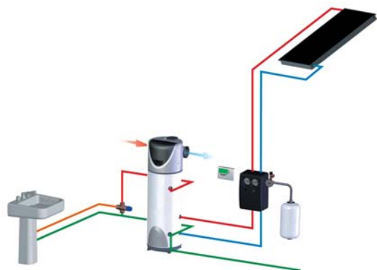
Рис. 1. Схема ГВС с гелиоколлектором компании Ariston
