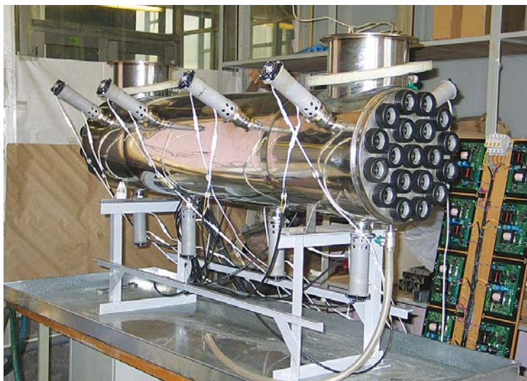
Установка для обеззараживания воды комбинированным воздействием ультразвука и ультрафиолетового облучения «Лазурь М 250»
