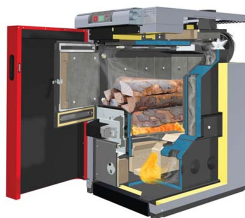
Рис. 5. Сжигание древесного топлива в пиролизном котле (схема)
