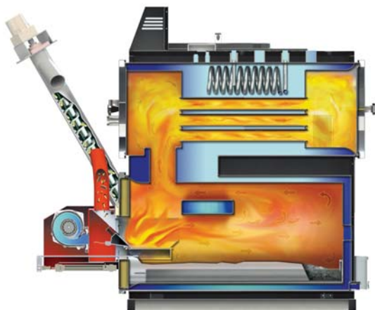
Рис. 8. Сжигание топлива в пеллетном котле (схема)
