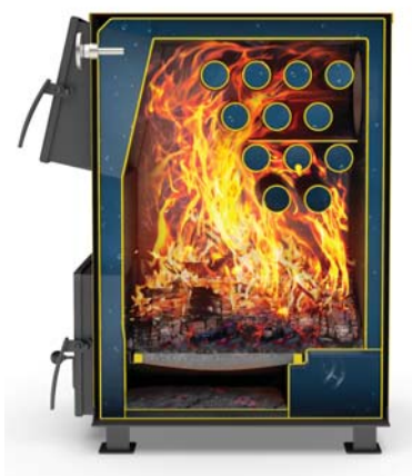
Рис. 3. Твердотопливный котел длительного горения с традиционным сжиганием (снизу–вверх) (схема)
