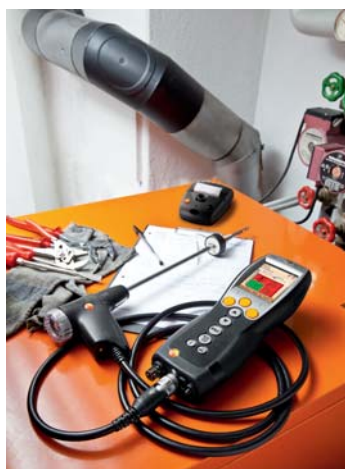
Testo 330 – наиболее подходящий прибор для контроля выбросов дымовых газов от твердотопливных котлов
