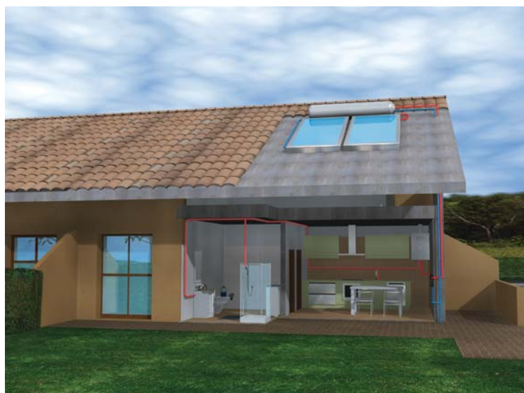
Рис. 3. Схема ГВС с плоским гелиоколлектором
