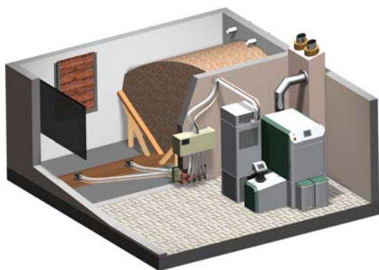
Рис. 7. Котельная на основе пеллетного котла с хранилищем пеллет (схема)
