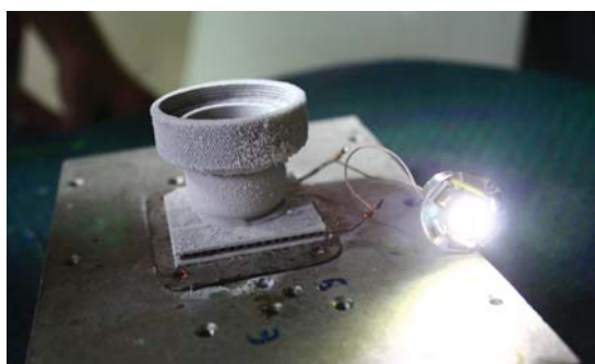
Рис. 7. Термоэлектрический ТН в режиме генерации тока
