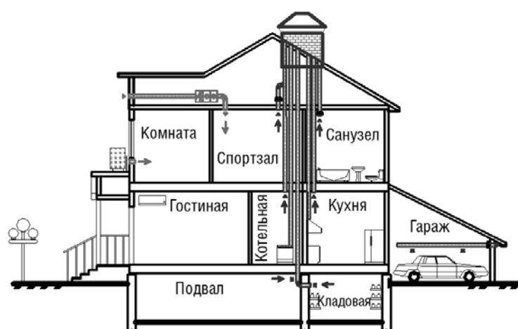
Рис.1. Комбинированная система вентиляции коттеджа
