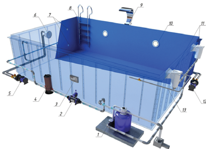
Рис. 4. Схема скиммерного бассейна: 1 – фильтровальная установка; 2 – теплообменник; 3 – устройство управления фильтровальной установкой и теплообменником; 4 – дозатор хлора; 5 – насос противотока; 6 – форсунка противотока; 7 – стеновые форсунки возврата воды; 8 – лестница; 9 – труба водопада; 10 – подводный прожектор; 11 – скиммер; 12 – насос водопада; 13 – труба для подпитки свежей воды
