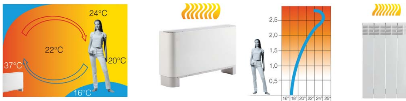
Рис. 2. Распределение температуры при радиаторном отоплении
