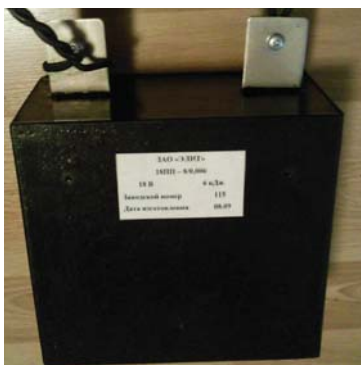
Рис. 3. Электрохимический конденсатор ЗАО «Элит» с запасом энергии 6 кДж и напряжением 18 В
