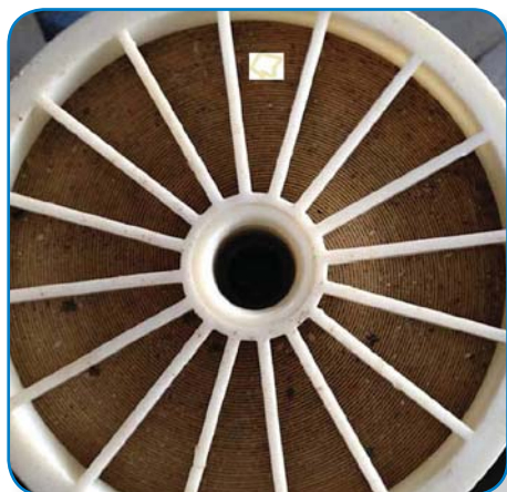
Рис.3 Пример засорения торцевой области головного МРЭ
