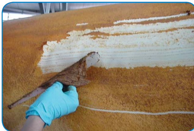
Рис.1. Пример необратимого загрязнения МРЭ отложениями - вид при аутопсии
