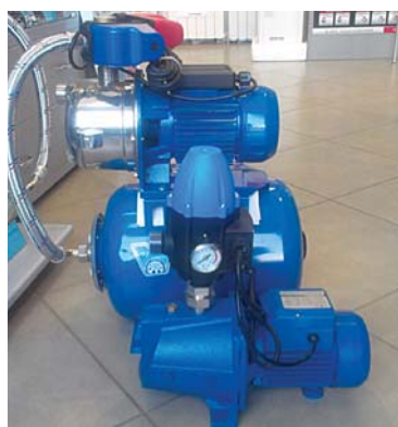
Рис. 8. Насосы, оборудованные механической группой автоматики (на заднем плане) и электронным блоком автоматики
