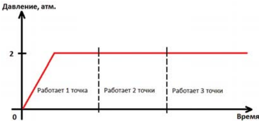
Рис. 10. График работы насоса, оборудованного ЭБА с частотным преобразователем
