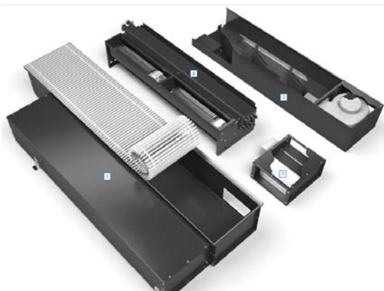
Рис. 7. Встраиваемый в пол конвектор с подачей наружного воздуха Venta. Модули: 1 – основной с декоративной рамкой; 2 – приточного воздуха с аксиальным вентилятором, системой шумоглушения и микропроцессорным регулятором; 3 – забора приточного воздуха; 4 – рециркуляционного воздуха с тангенциальными вентиляторами
