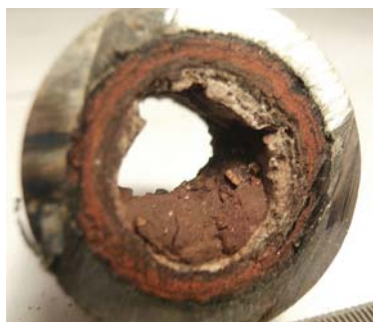
Рис. 4. Твердые отложения накипи на стенках трубки теплообменника водогрейного котла
