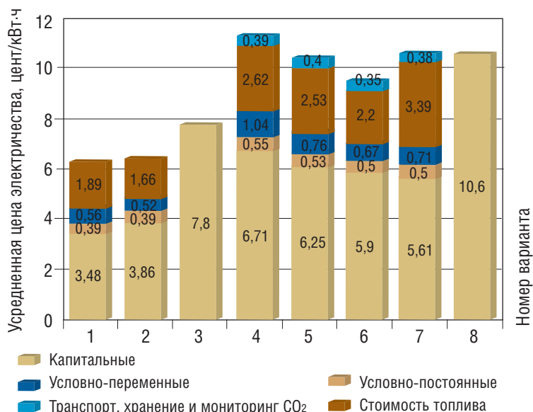
Рис. 2 Усредненная стоимость электроэнергии пылеугольных энергоблоков без улавливания и с улавливанием CO 2 различными способами: 1–3 – традиционное сжигание с использованием воздуха: параметры СКД (23,8 МПа, 599/621 °C); СКП (27,2 МПа, 732/760 °C) и блок с внутрицикловой газификацией; 4–8 – сжигание с улавливанием CO 2 : параметры СКД, использование воздуха и улавливание CO 2 за котлом; блок СКД, технология oxy-combustion с криогенной ВРУ; блок СКД, технология B&W с «горячей» рециркуляцией; блок СКД и воздухоразделительная установка мембранного типа; блок с внутрицикловой газификацией и с улавливанием CO 2
