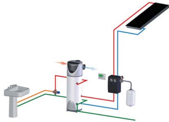
Рис. 2. Схема ГВС компании Ariston с водонагревателем NUOS (ТН) и солнечным коллектором
