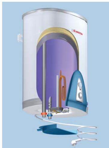
Рис. 5. Принципиальная конструкция электрического накопительного водонагревателя
