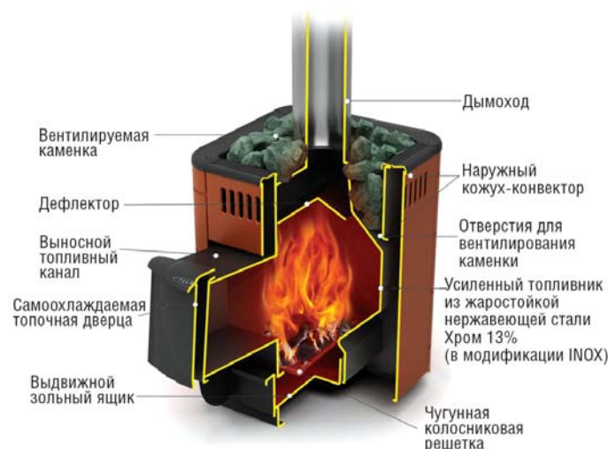
Рис. 3. Схема работы печи «Оса INOX»
