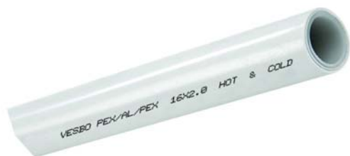
Рис. 2. Металлопластиковая труба PE-X-AL-PE-X с внешним и внутренним слоями из сшитого полиэтилена и средним антидиффузионным слоем из алюминия
