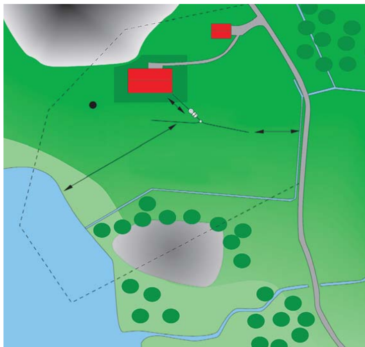
Рис. 4. Рекомендованная схема расположения очистного сооружения Уропор Sako на земельном участке (точные расстояния, на которые влияют, в частности, параметры грунта, определяются в каждом конкретном случае отдельно)
