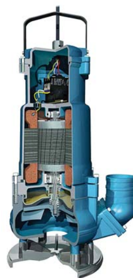
Рис. 2. Принципиальная конструкция фекального насоса
