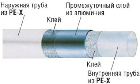
Рис. 7. Структура пятислойной композитной трубы PE-X-AL-PE-X
