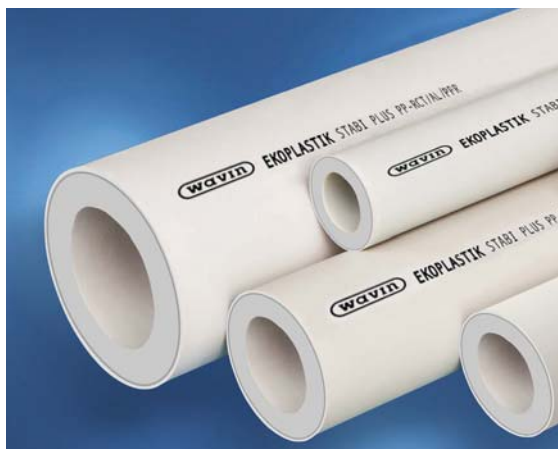
PP-RST-AL-PP-R трубы: наружный слой выполнен из PP-RCT полимера, средний слой – из алюминия, внутренний – из PP-R полимера
