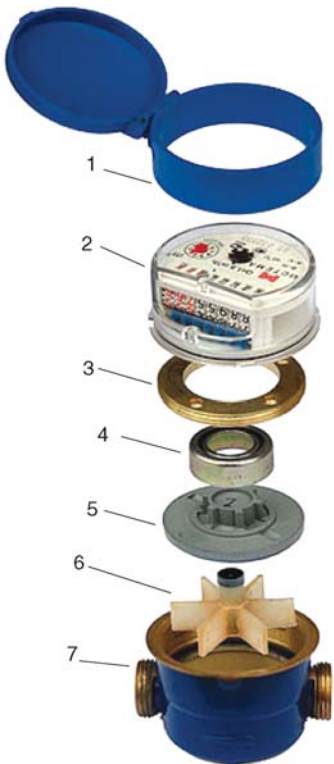
Рис. 3. Основные элементы водосчетчика «Мультисистема»: 1 – корпус верхний с крышкой; 2 – головка счетчика; 3 – гайка-фиксатор; 4 – кольца магнитной защиты; 5 – магнитная муфта; 6 – крыльчатка; 7 – корпус крыльчатки
