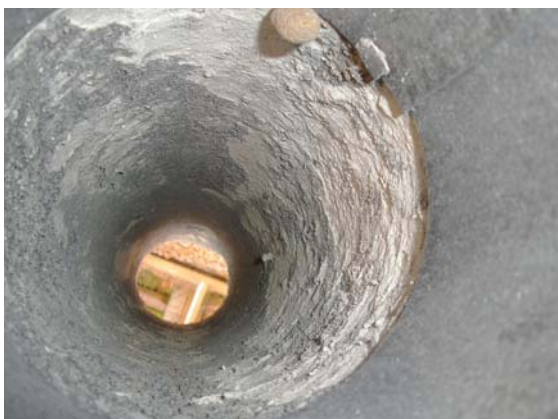
Разрушение напорной асбестоцементной трубы конденсатом после двух лет эксплуатации
