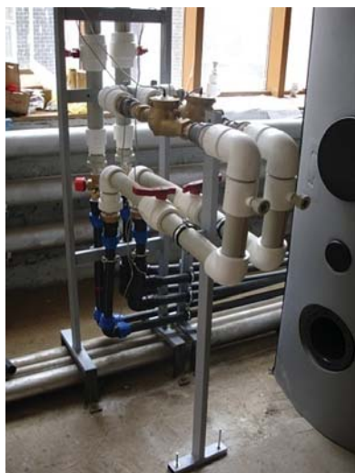
Рис. 1. Стенды для испытания тепловых насосов (ГУП «НИИМосстрой»)
