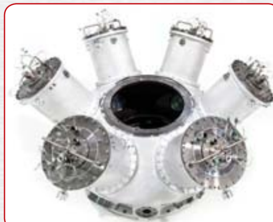
Шесть камер сгорания УТКС, которые отлаживают для тестирования
