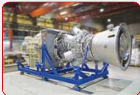
Новая одновальная газовая турбина MGT 6100 до монтажа на стенде для испытания в г. Оберхаузен
