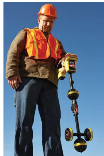
Рис. 3 Локализация инженерных сетей с помощью трассоискателя
