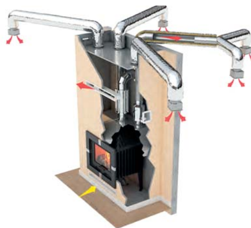
Рис. 2. Дровяная печь-камин со светопрозрачным экраном в системе воздушного отопления
