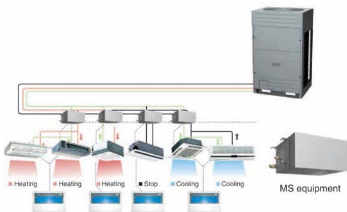
Рис. 4. Схема работы VRF-системы в режиме нагрева/охлаждения
