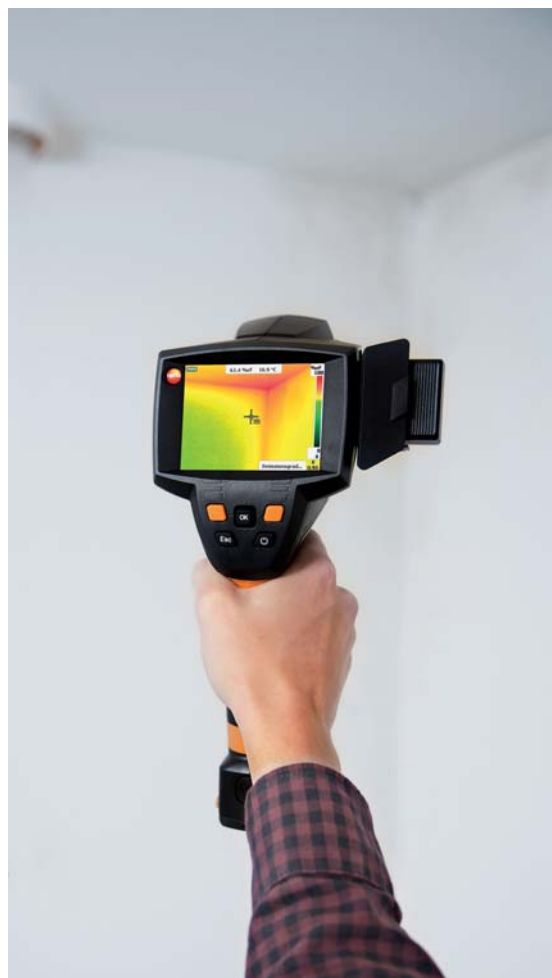
Распределение поверхностной влажности в тепловизоре отображается в виде цветовой палитры типа «светофор»
