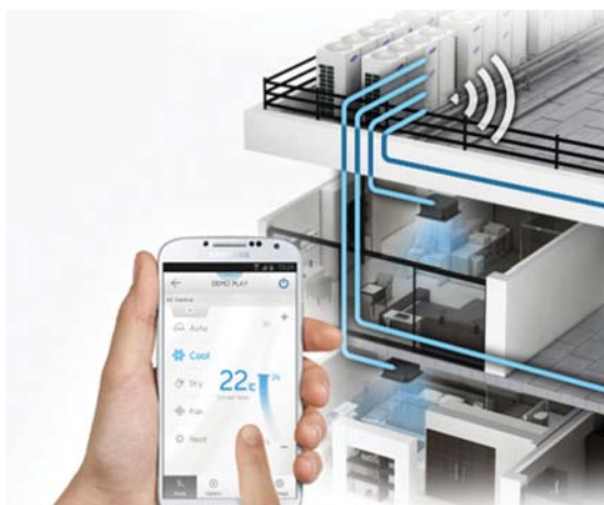
Рис. 7. Посредством одного Wi-Fi модуля можно контролировать через смартфон до 16-ти внутренних блоков
