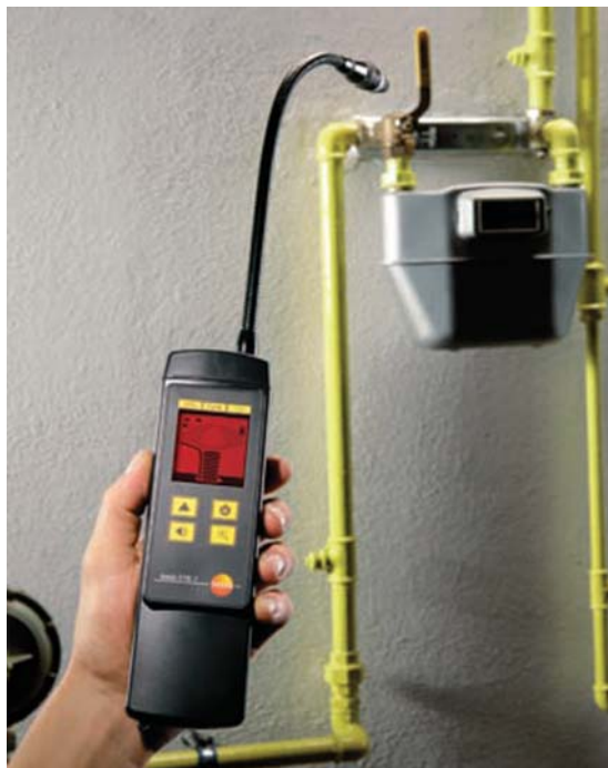
Рис. 3 Проверка на утечку природного газа
