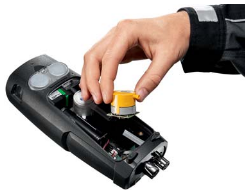
Рис. 1 Сменный сенсор газоанализатора вместе с платой управления им.
