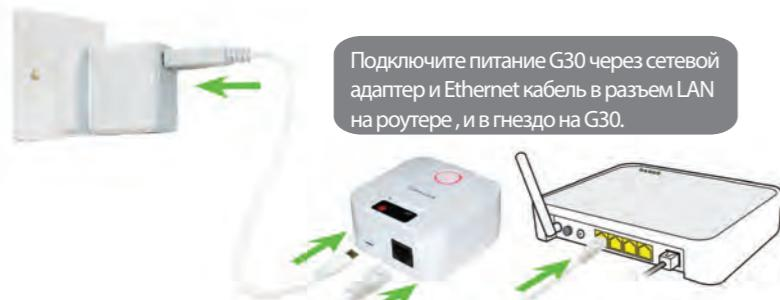
Подключите питание G30 через сетевой адаптер и Ethernet кабель в разъем LAN на роутере, и в гнездо на G30.
