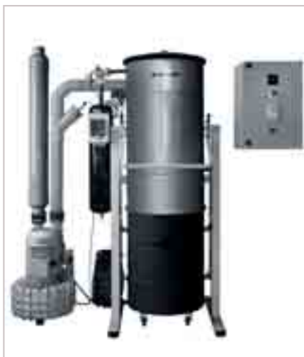
Силовой блок Blizzard Lufttechnik P-klasse: двигатель Siemens, сепаратор с компрессором автоматической очистки фильтра, шкаф управления с инвертором и микропроцессором системы управления
