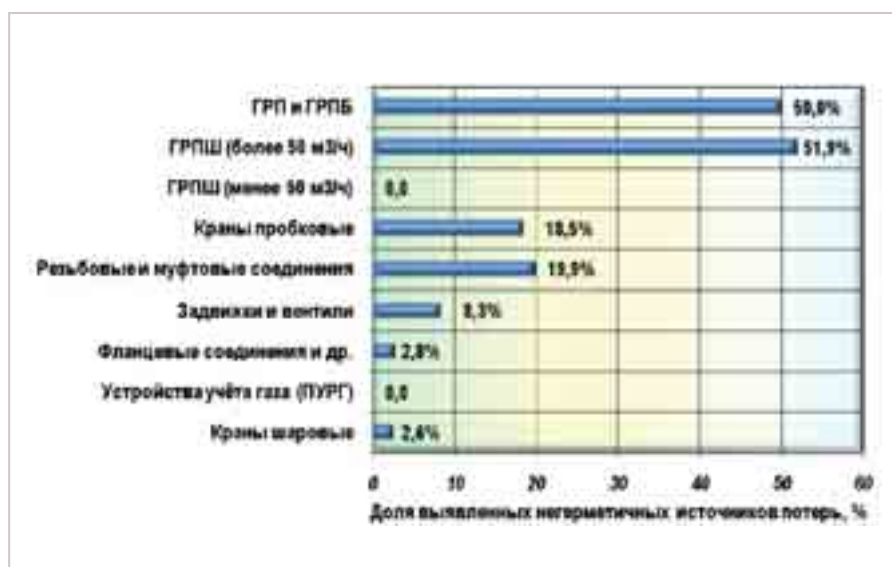
Рис. 4. Результаты измерений утечек газа в обследованной ГРО
