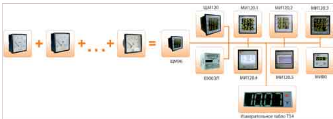
Рис. 1. Пример замены стрелочных приборов многофункциональными
