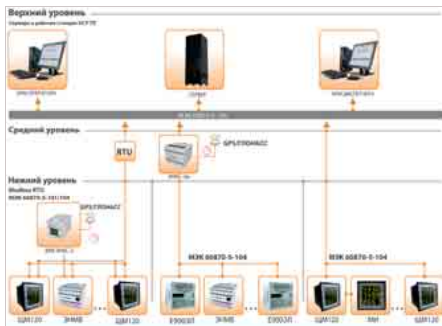
Рис. 4. Пример интеграции многофункциональных приборов в АСУ ТП
