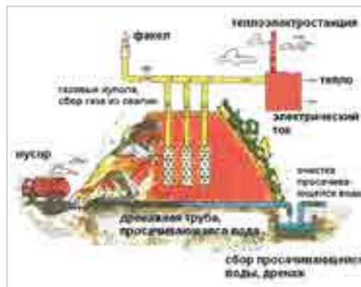
Схема получения газа из твердых бытовых отходов
