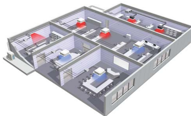
Рис. 2. Пример трехтрубной VRF-системы
