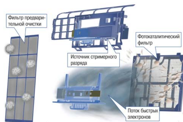
Рис. 3. Многоступенчатая очистка воздуха с помощью комбинированного фильтра, работа которого основана на механическом, электростатическом, адсорбционном, бактерицидном и фотокаталитическом принципах
