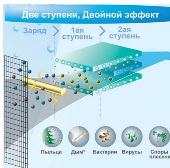
Рис. 2. Схема работы плазменного фильтра
