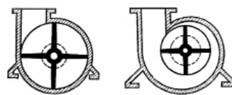
Рис.5. Центробежный насос Папена со спиральным корпусом
