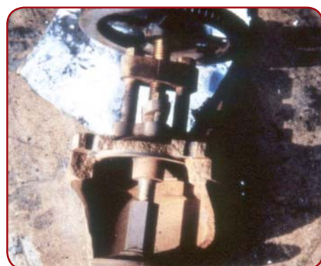
Рис. 2. Гидравлические удары постепенно привели к выходу клапана из строя
