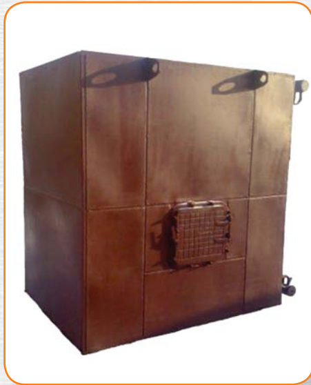
Стальной экономайзер в виде транспортного блока. Обшит металлическими листами. С правого торца видны входной (снизу) и выходной (сверху) коллекторы. В центре – лаз в пространство между пакетами змеевиков. Вход продуктов сгорания сверху, выход – снизу.
