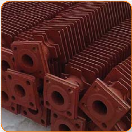
Чугунные трубы монтируются фланцами впритык так, что фланцы образуют торцевую стенку экономайзера. Уплотнение стенки производится асбестовым шнуром, который укладывается в канавки между фланцами. Движение воды по трубам осуществляется через полукруглые калачи.
