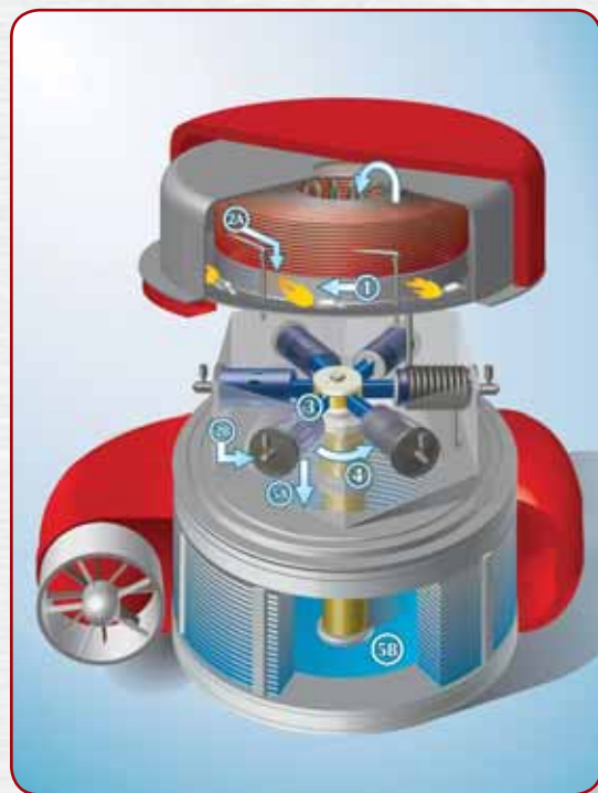
Рис. 1. Паромоторный энергоблок «Циклон» для мини-ТЭЦ (патент US 7,080,512).
