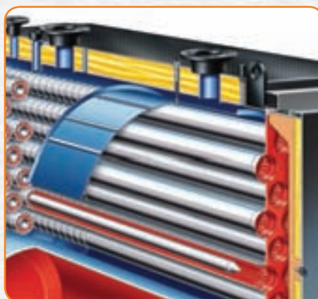
Рисунок 2. Спиралевидные завихрители из жаропрочной стали в дымогарных трубках водогрейного жаротрубного котла
